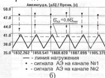
Рис. 7. Электронная топограмма усталостной зоны излома образца, показывающая бороздчатый микрорельеф (а), и регистрация сигналов акустической эмиссии от процесса формирования бороздчатого микрорельефа (б)
