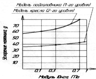
Рис. 14. Ускорение маятника в зависимости от значения модуля Юнга материала набивки подголовника (модели 1-го и 2-го уровней)
