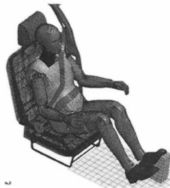
Рис. 23. КЭМ кресла с установленным манекеном
