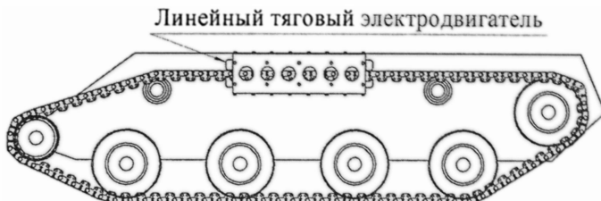
Рис. 1. Схема шасси гусеничной машины с линейным тяговым электродвигателем
