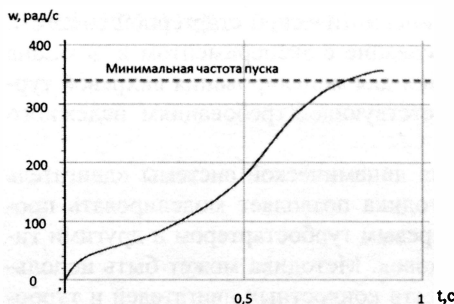
Рис.14. Изменение частоты вращения ротора турбины
