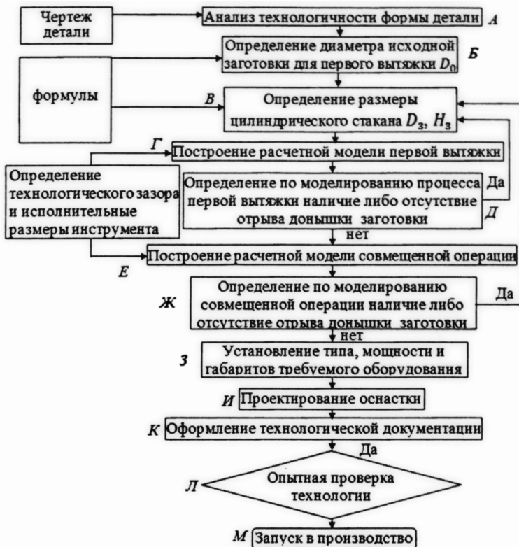
Рис. 14. Алгоритм проектирования технологических процессов совмещенной вытяжки с обжимом и раздачей для получения деталей с раструбом
