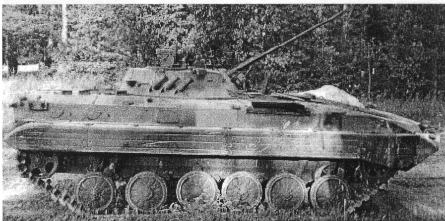
Рис 4. Боевая машина пехоты БМП-2
