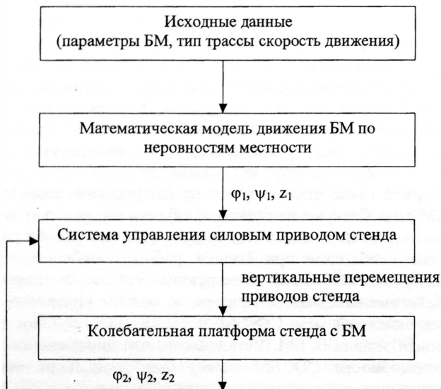
Рис. 1. Структурная схема динамического стенда для оценки работоспособности СО БМ
