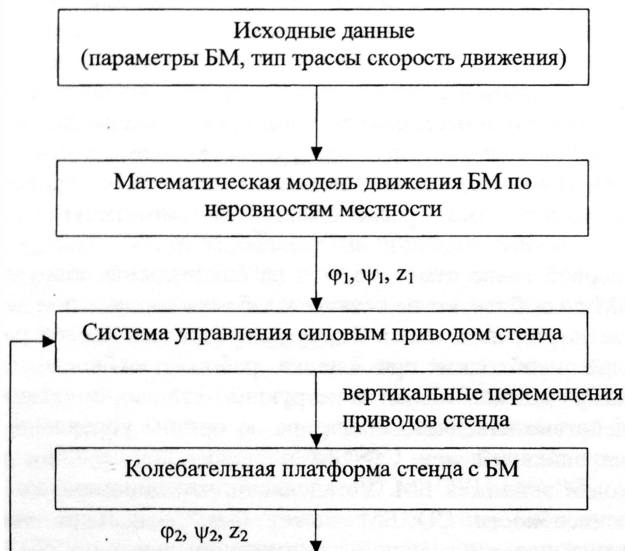
Рис. 1. Структурная схема динамического стенда для оценки работоспособности СО БМ
