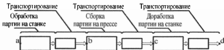
Рис. 2. Организация производства на основе последовательного выполнения обрабатывающих и сборочных процессов
