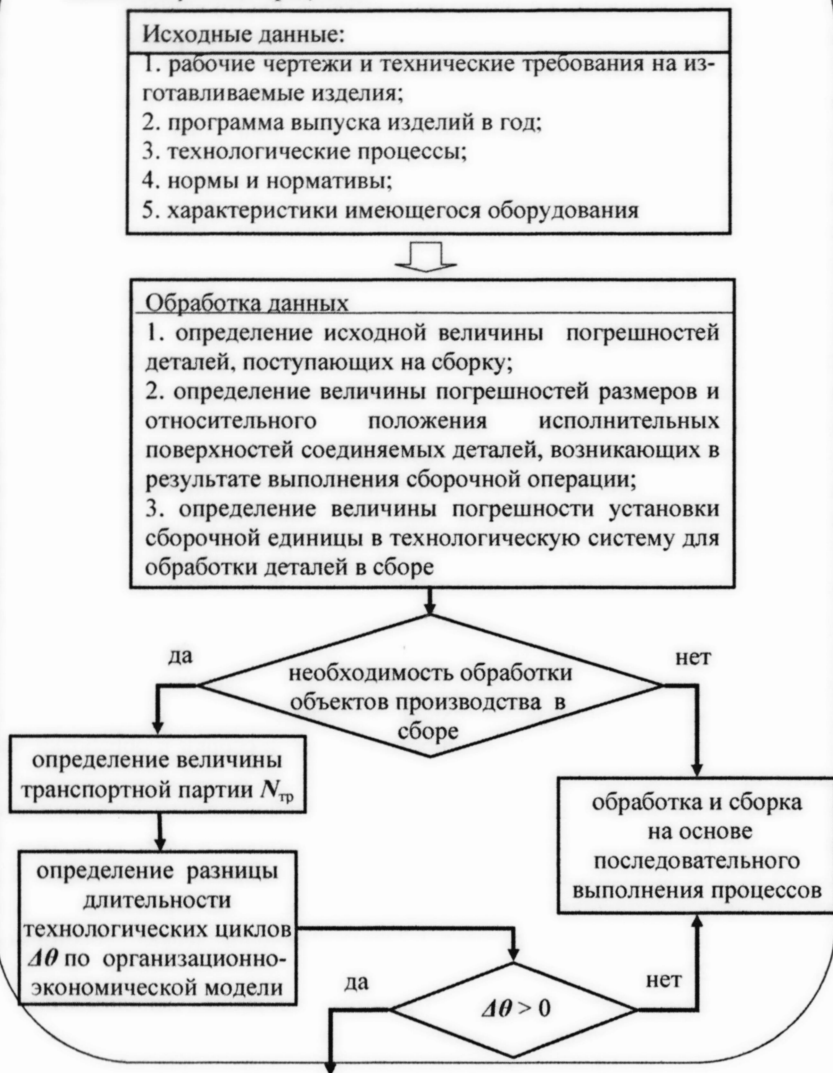
Рис. 5. Схема процесса организации технологических систем, реализующих механосборочные процессы, на основе выявления функционально-параметрической общности процессов сборки и обработки
