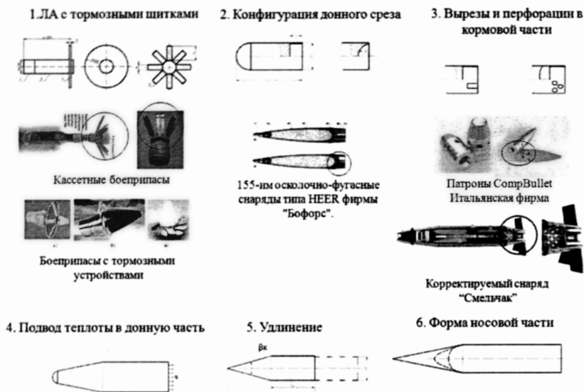
Рис. 1. Исследуемые варианты управления обтеканием ЛА
