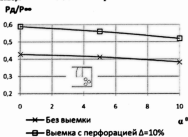
Рис. 12. Зависимость относительного донного давления от угла атаки
