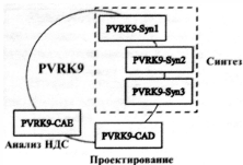
Рис. 13. Структура пакета PVRK9
