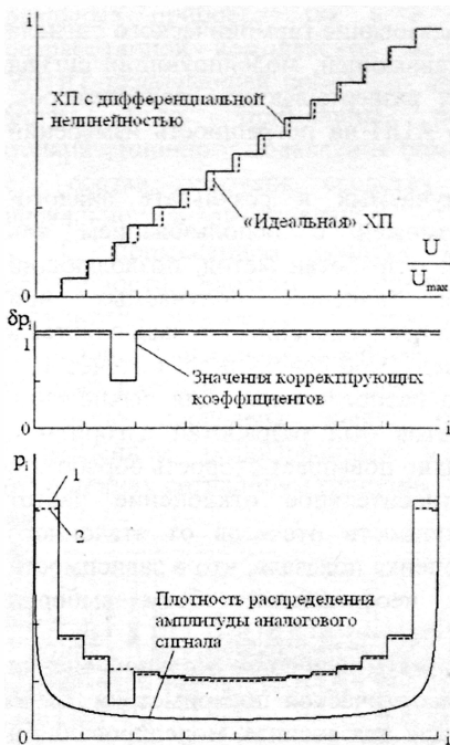
Рисунок 7. Влияние дифференциальной нелинейности на распределение значений отсчетов при преобразовании гармонического сигнала: 1, 2 – частоты появления значений отсчетов при «идеальной» ХП и ХП с дифференциальной нелинейностью
