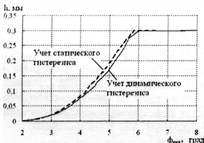
Рис. 7. Ход якоря ЭМП в зависимости от угла поворота кулачка
