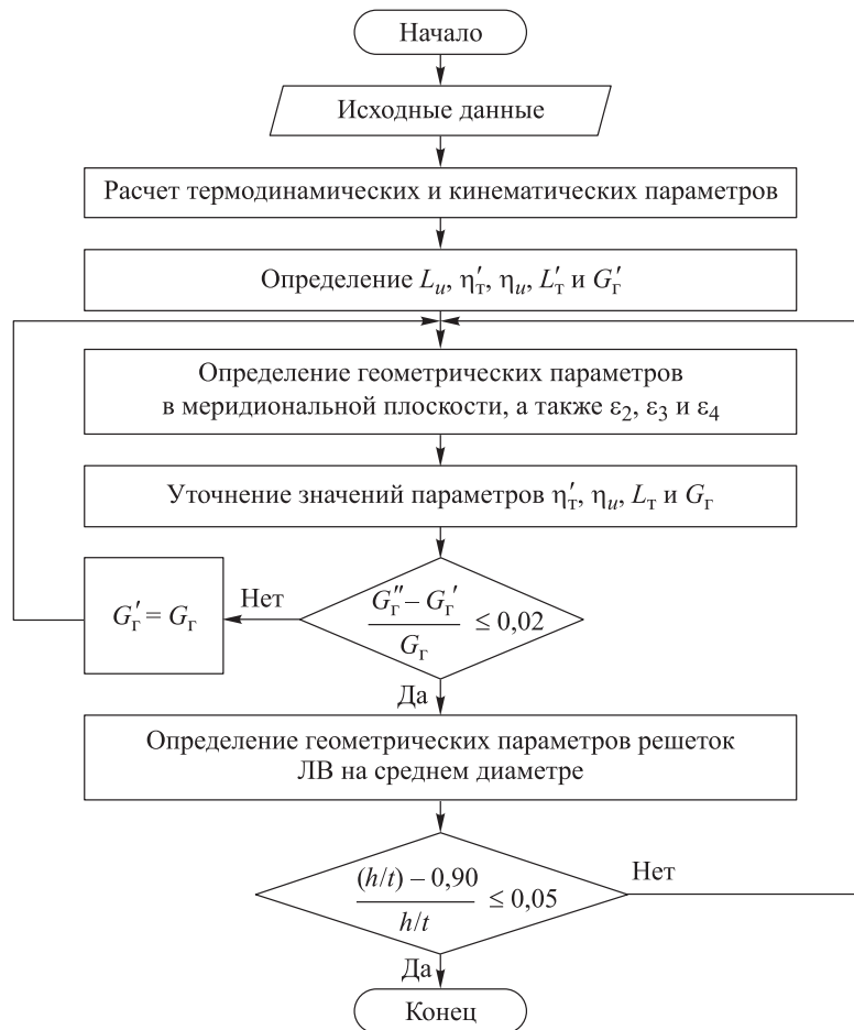
Рис. 3. Блок-схема алгоритма третьего этапа оценки параметров ТПА на среднем диаметре
