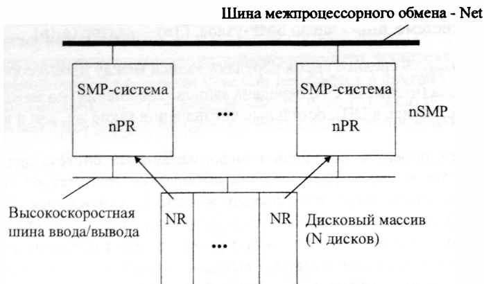
Рис. 2. Общая схема комплекса, состоящего из нескольких SMP- систем
