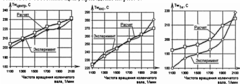
Рис. 7. Температуры поршня в характерных зонах: T_{w_{\text{центр}}} – в центре камеры сгорания, T_{w_{\text{ккс}}} – на кромке камеры сгорания, T_{w_{1к}} – в районе 1 кольца
