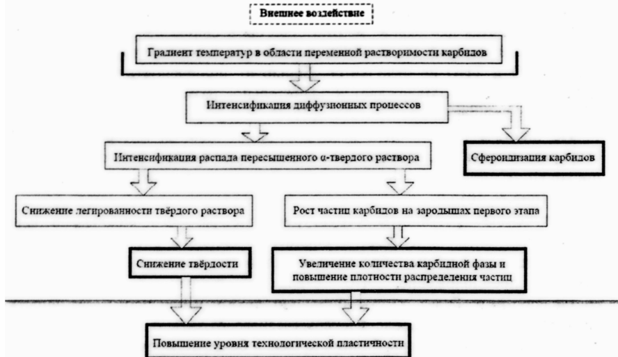
Рис. 10. Гипотетическая схема фазовых и структурных превращений при термоциклическом отжиге быстрорежущих сталей на втором этапе термоциклического отжига ( \alpha -область)
