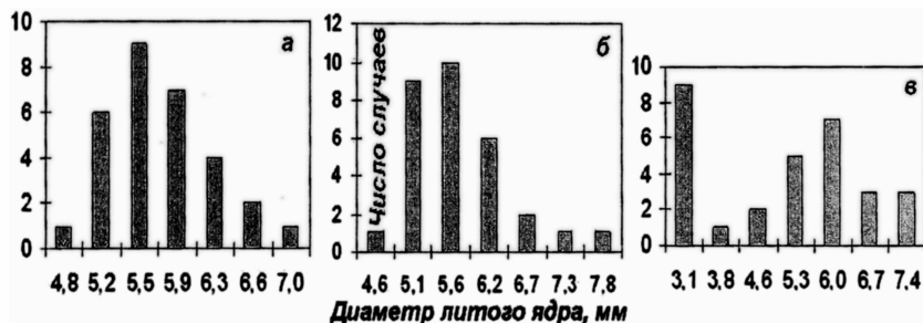
Рис. 4. Гистограммы распределения размера диаметра литого ядра при различных условиях сварки:
