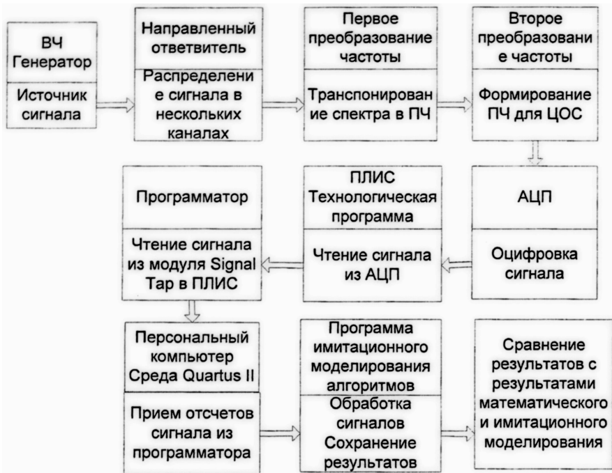
Рисунок 2 Схема проведения экспериментального исследования
