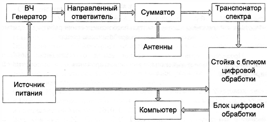
Рисунок 3 Схема испытательного стенда
