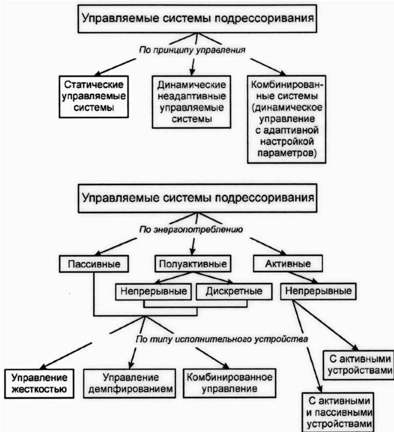
Рис. 1. Классификатор управляемых систем поддрессирования многоосных колесных машин
