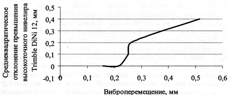
Рисунок 8. Зависимость среднеквадратического отклонения превышения высокоточного нивелира Trimble DiNi 12 от виброперемещения
