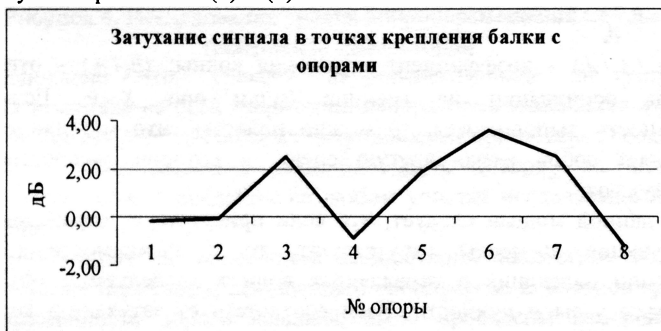
Рисунок 6. Затухание сигнала в точках крепления балки с опорами
