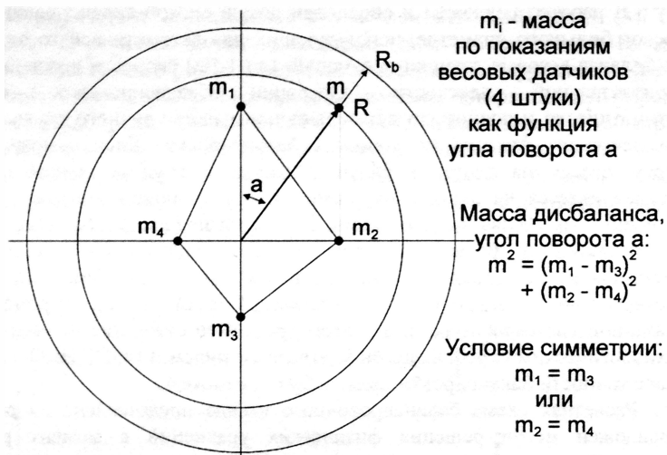
Рис. 7. Расчетная схема балансировочного стенда: условие симметрии
