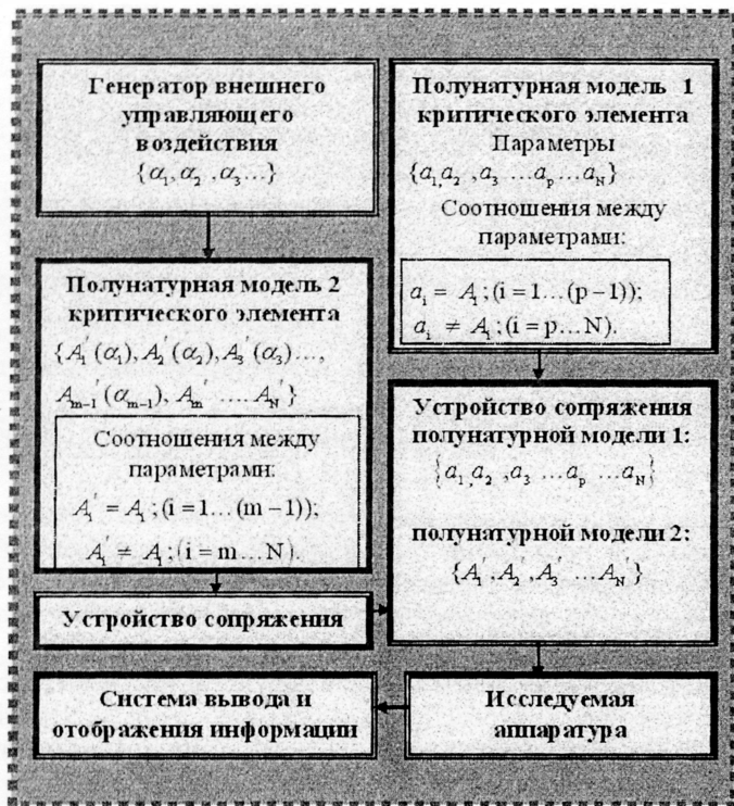
Рис. 1. Структурная схема полунатурной модели исследуемой системы с полунатурной моделью критического элемента
