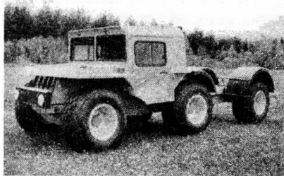
Рис. 1. Вездеходное транспортное средство «ЗЭТ 6×6» со стеклопластиковыми четверть-эллиптическими рессорами
