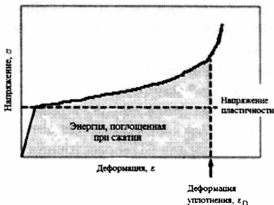
Рис. 1. Схематичная кривая, иллюстрирующая энергопоглощающие свойства ПЭМ
