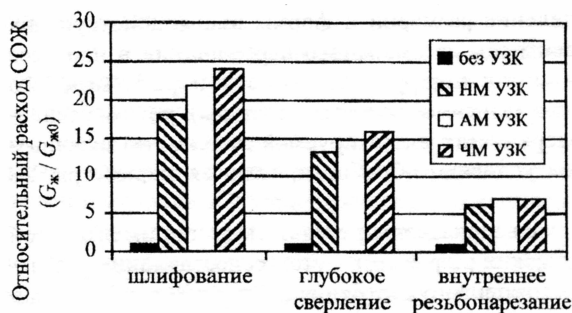
Рис. 3. Относительный расход СОЖ непосредственно через зону механической обработки с применением УЗ техники подачи: аббревиатуры см. в табл. 1
