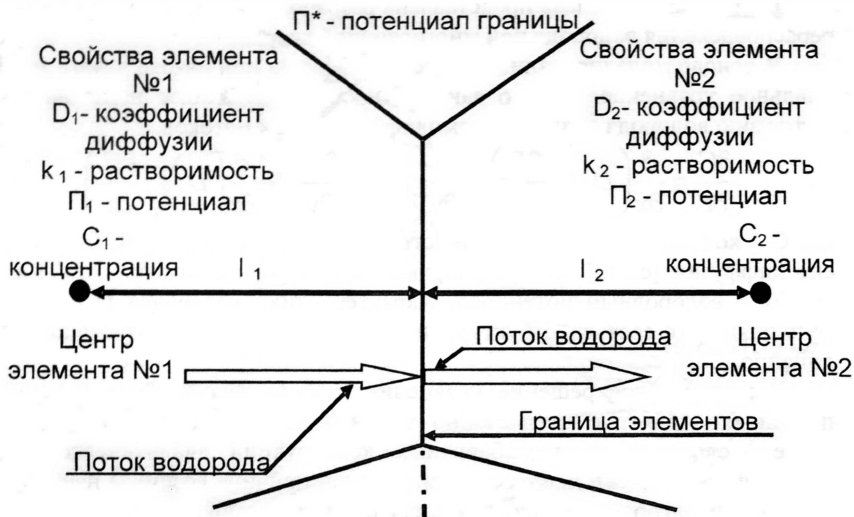
Рис. 2. Взаимодействие между элементами и диффузия водорода через границу элементов.
