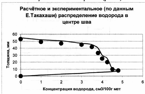
Рис.7. Сравнение экспериментальных данных Е.Takahashi и результатов расчёта. Точками обозначены экспериментальные данные, линией – расчётные
