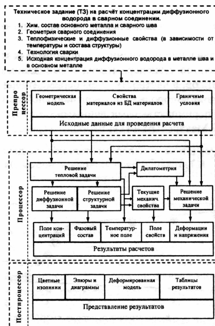
Рис. 5. Блок - схема решения диффузионной задачи с помощью НИПК «Сварка»
