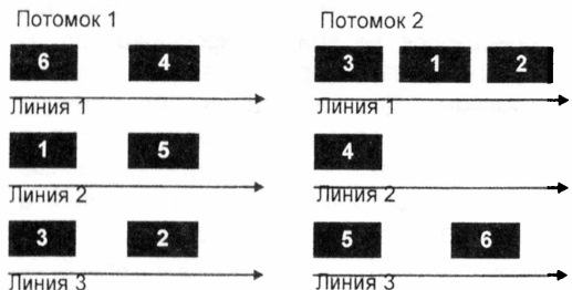
Рис.9. Результат перераспределения работ при использовании модифицированного кроссинговера
