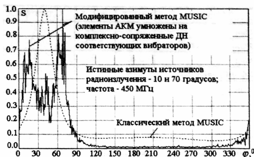
Рис. 23. Сохранение высокой разрешающей способности на резонансной частоте
