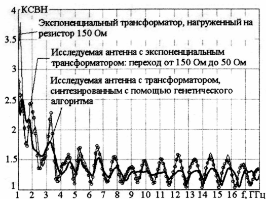
Рис. 22. Анализ эффективности синтезированного полоскового трансформатора
