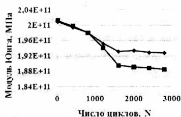
Рис. 3. Зависимость модуля Юнга от числа циклов, сталь 08Х18Н10Т
