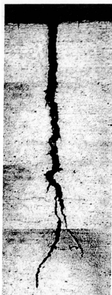
Рис. 1. Трещина в образце 08Х18Н10Т, \Delta\varepsilon = 0,3 , N^* = 845 циклов, \times 135
