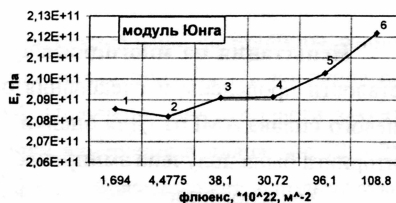
Рис. 8. Влияние флюенса нейтронов на упругие характеристики, сталь 15Х2МФА а) модуль сдвига, б) модуль Юнга
