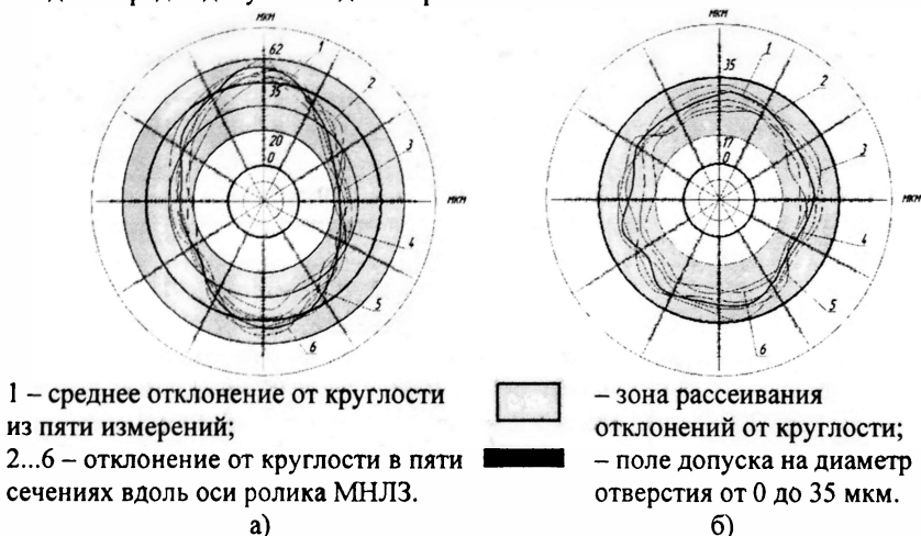
Рис.2. Типовые круглограммы отверстий роликов (увеличение \times 1000 ) при базировании на станках: а) глубоко-сверлильном модели РТ293164 в трехкулачковом патроне и люнете; б) горизонтально-расточном модели ЛР543ПМФ4 в узких призмах
