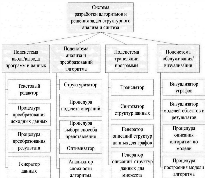
Рис. 7. Структура системы разработки алгоритмов и решения задач структурного анализа и синтеза
