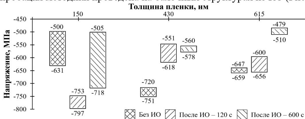
Рисунок 9. Влияние толщины Al 2 O 3 и времени ИО покрытия на подложке КС
