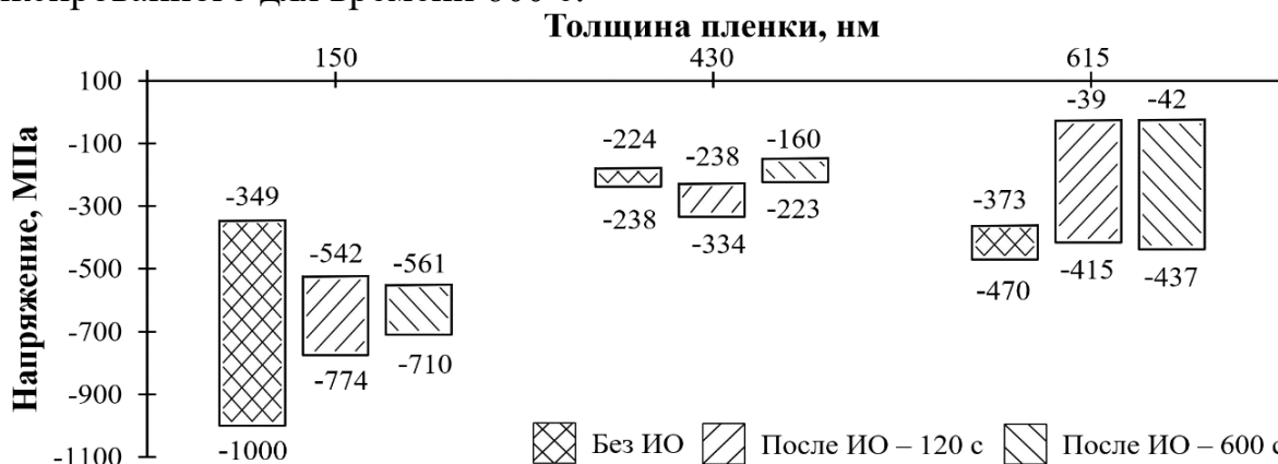
Рисунок 7. Влияние толщины \text{Al}_2\text{O}_3 и времени ИО покрытия на подложке Si
