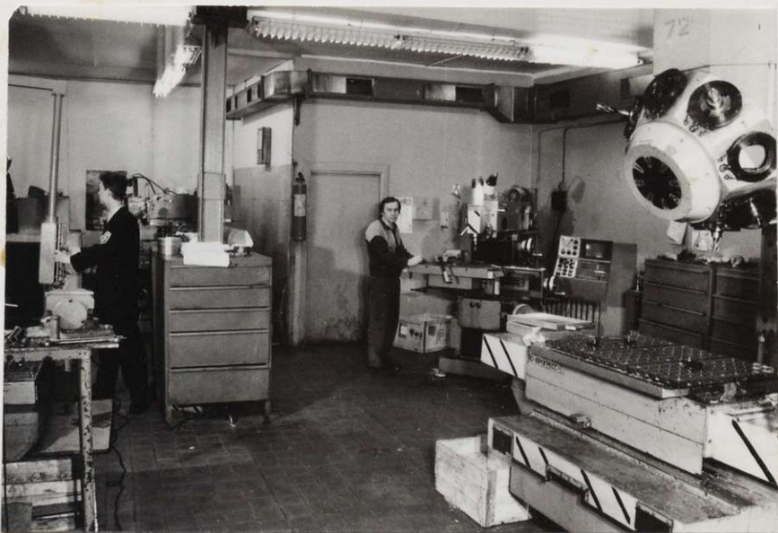
Станки с ЧПУ. Фрезерный модуль 67K25ПФ2. Обрабатывающий фрезерный центр МА-655-2А
