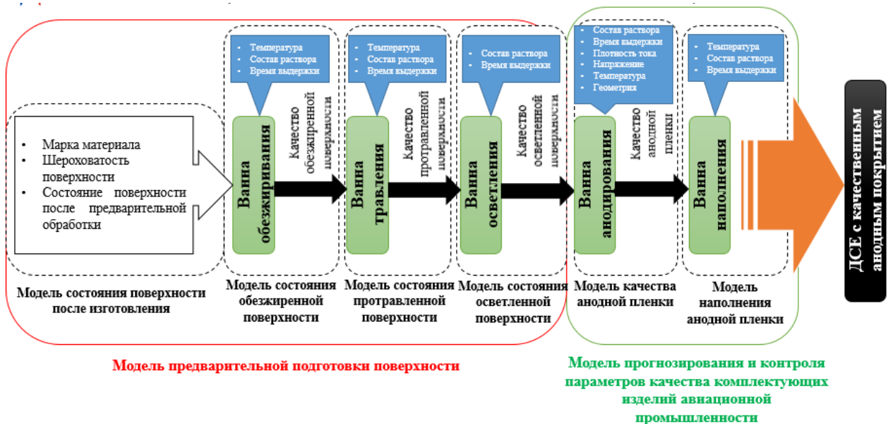
Рисунок 4.9 – Структурная схема имитационной модели гальванической линии анодного оксидирования
