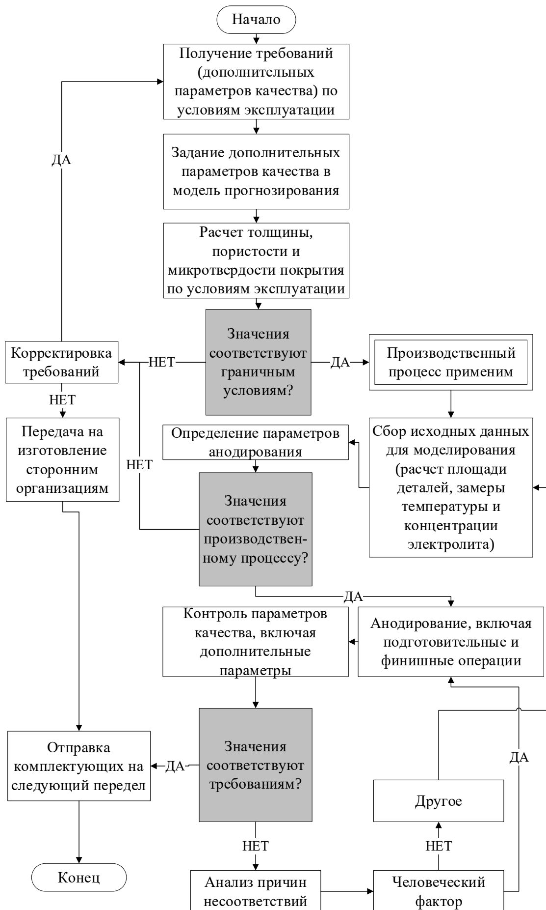
Рисунок 4 – Алгоритм прогнозирования параметров качества комплектующих изделий авиационной промышленности
