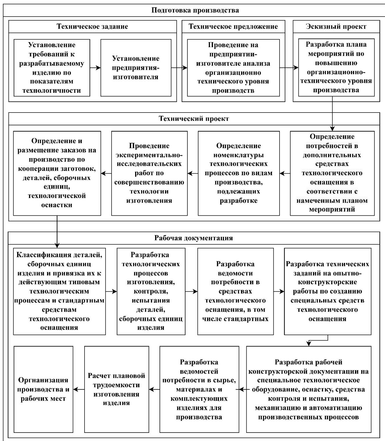
Рис. 1.5. Структурная схема подготовки производства
