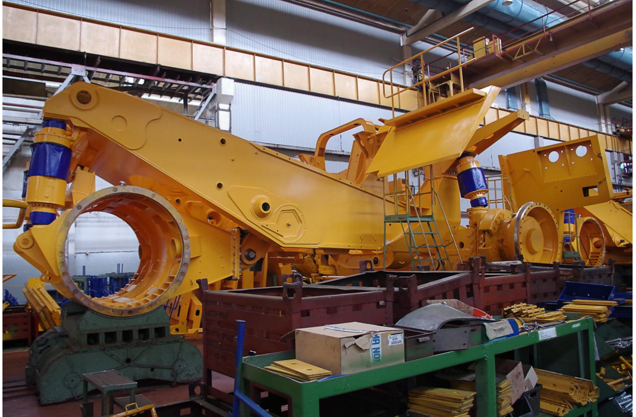
Рис. 1.3. Сборка передней подвески БелАЗ
