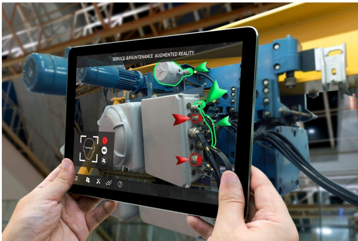
Рис. 1.9. Обслуживание силовых установок на производстве с использованием технологии дополненной реальности
