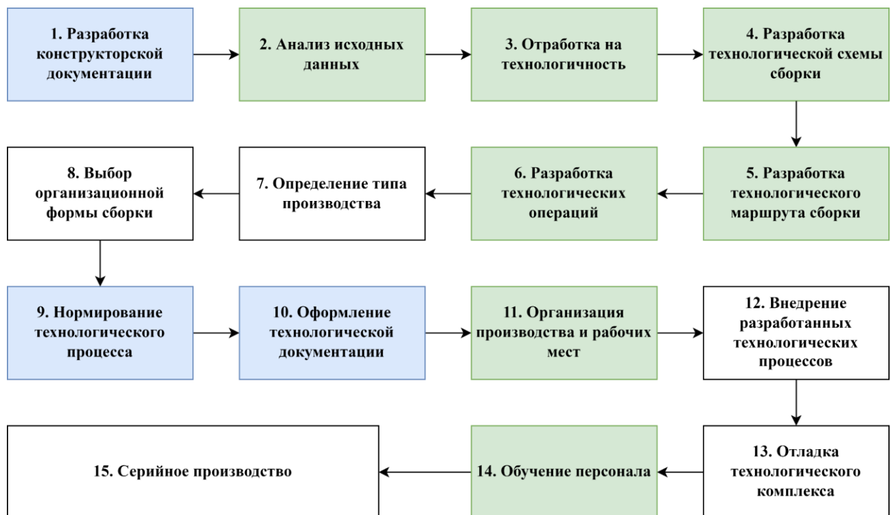
Рис. 2.1. Основные этапы подготовки производства сборки крупногабаритных изделий
