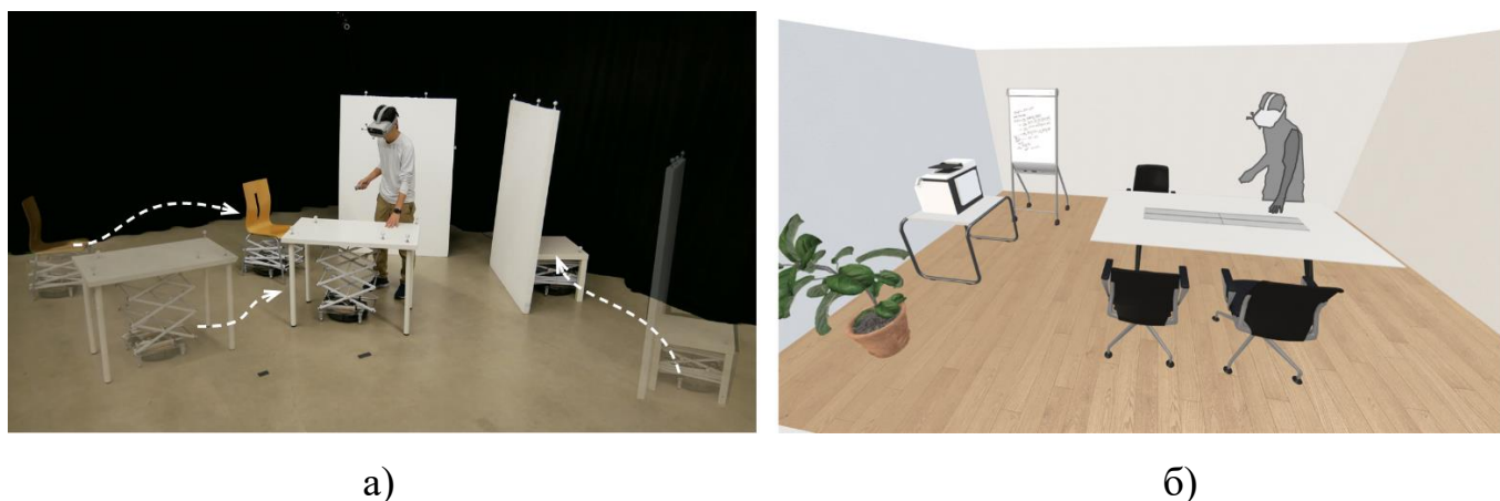
Рис. 1.7. Реализация концепции комнаты VR с перемещающимися объектами а – физическое перемещение объектов в комнате, б – визуализация в среде виртуальной реальности.
