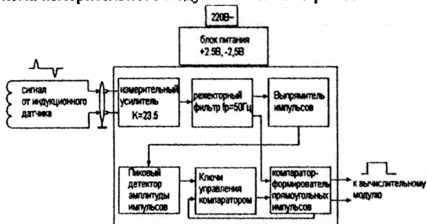
Рис.5. Блок-схема измерительного модуля системы фазо-хронометрического сопровождения турбоагрегата.
