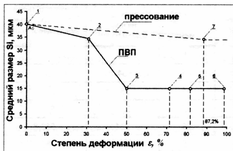
Рис. 11 Диаграмма изменения средних размеров кристаллов первичного кремния в структуре слитка и прутков diam. 92-14 мм после ПВП и прессования с разной степенью деформации:
