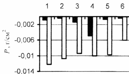
Рис. 4. Удельное изменение массы образцов после 609 (черный) и 3609 (белый) циклов испытаний (1 - АК4-1Т1 без покрытия; 2 - АК4-1Т1 с анодированным покрытием; 3 - АМг2П; 4 - АМг4М; 5 - В91Т3; 6 - АД31Т)
