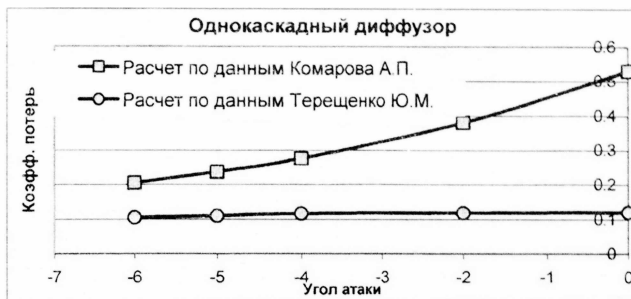
Рис. 8 Расчетное изменение коэффициента потерь однокаскадного диффузора
