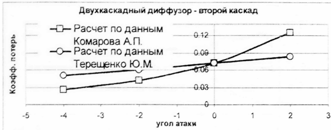
Рис. 10 Расчетное изменение коэффициента потерь на втором каскаде двухкаскадного диффузора
