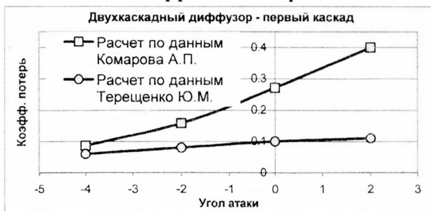
Рис. 9 Расчетное изменение коэффициента потерь на первом каскаде двухкаскадного диффузора
