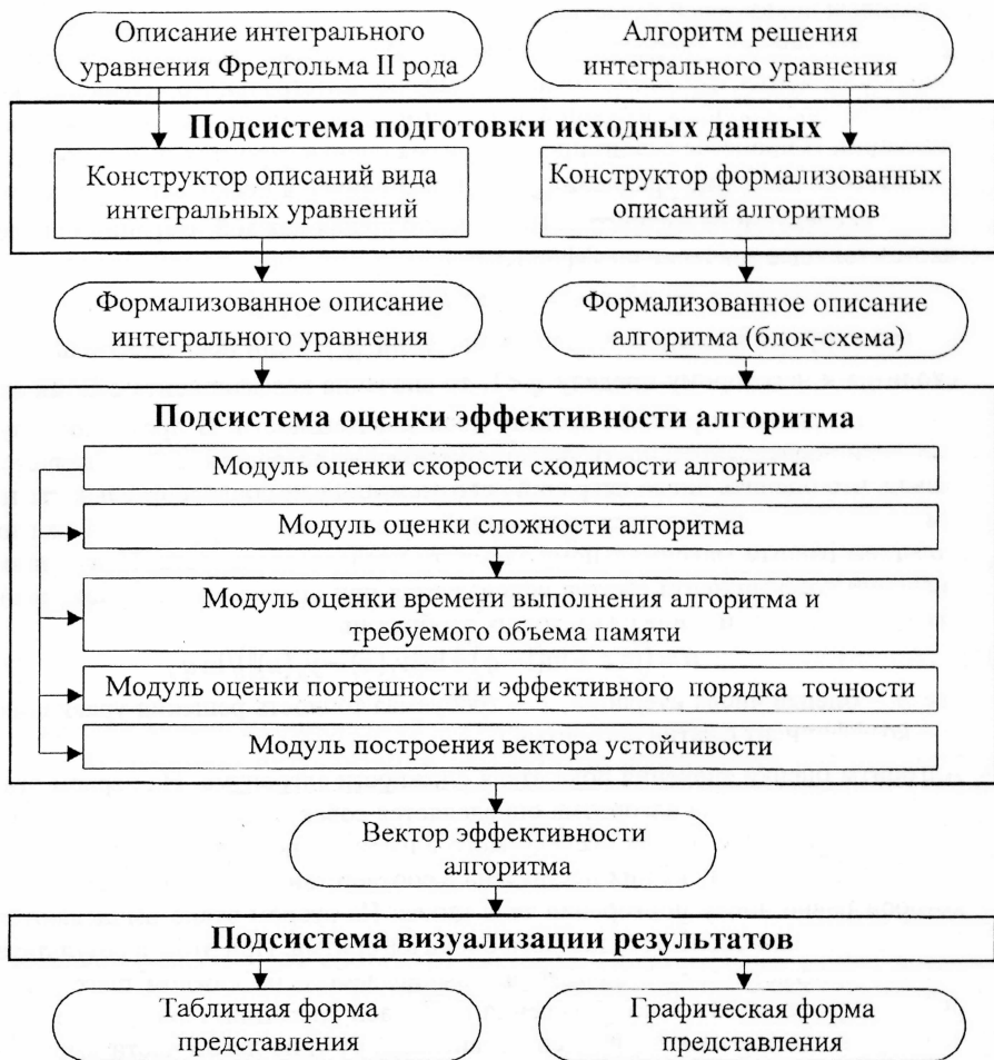
Рис. 2. Алгоритмическая структура программного комплекса
