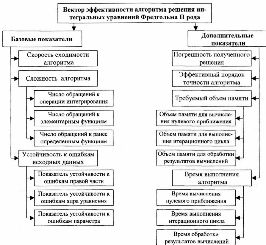
Рис. 1. Структура вектора эффективности алгоритма решения интегрального уравнения Фредгольма II рода
