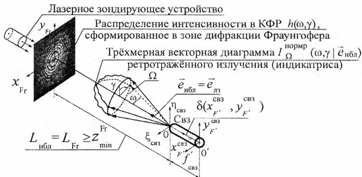
Рис. 1. Функциональная оптическая схема, идентифицирующая формирование КФР Свз в области дифракции Фраунгофера (в дальней зоне)
