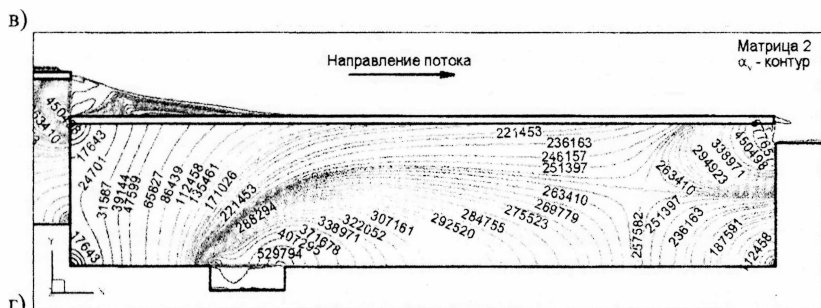
Рис. 6. Распределения температуры пористой стенки T_w (а,б) и объёмного коэффициента теплоотдачи \alpha_v (в,г) по телу I-ой и II-й пористых матриц; Nu_v рассчитывался по уравнению (14), G_{охл1}=0.0027 кг/сек, S_1=2.6 мм, G_{охл2}=0.004 кг/сек, S_2=1.3 мм, ширина матрицы 70 мм, длина 40 мм, высота 10 мм.
