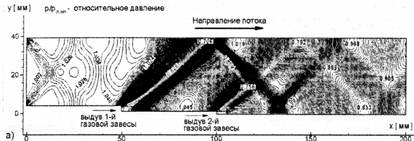
Рис. 2. Результаты расчёта основного потока, контуры давления при m_1 = (\rho u)_{slot1} / (\rho u)_{main} = 0.07 ; m_2 = (\rho u)_{slot2} / (\rho u)_{main} = 0.20 .
