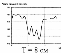
Рис. 10. Центральные сечения в распределении освещенности изображений шпальных мир с различными пространственными периодами штрихов T , полученные с помощью макетного образца ЛСВ
