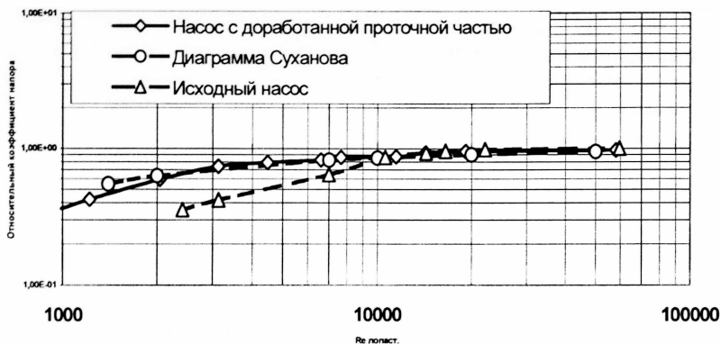
Рис. 12. Итоговые зависимости относительного безразмерного напора насоса от числа Рейнольдса
