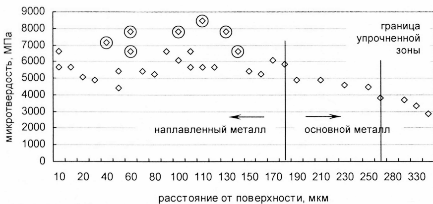
Рис. 6. Распределение микротвердости в напаянном слое
