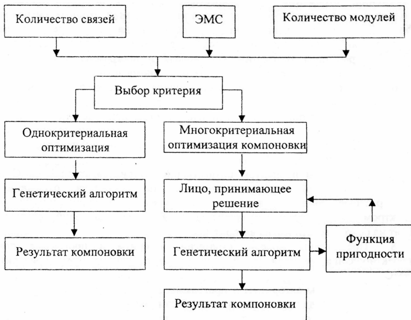
Рис. 4. Алгоритм решения задачи многокритериальной компоновки схем ЭС
