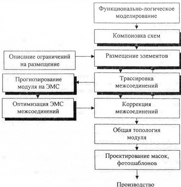
Рис. 1. Маршрут проектирования модулей ЭС
