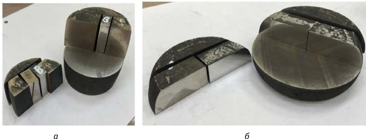
Рис. 2. Внешний вид разрезанных образцов со степенями деформации 10 % (а) и 50 % (б) для изготовления шлифов
